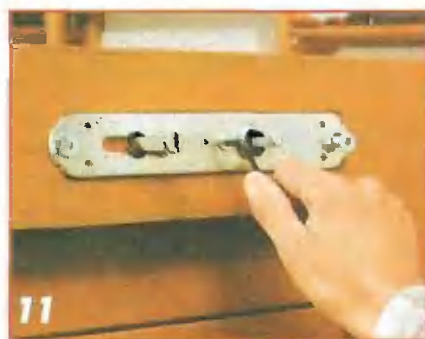
11 Обе дверные накладки крепятся винтами, заворачиваемыми через внутреннюю накладку.
