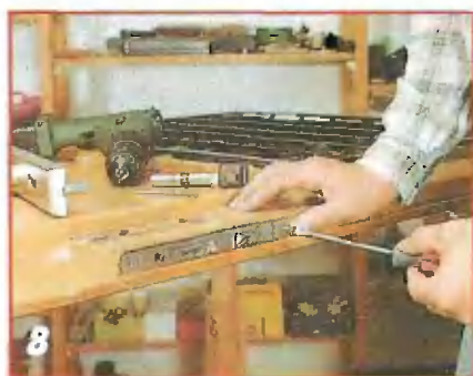
8 Теперь корпус замка можно установить на место. Под шурупы следует просверлить небольшие направляющие отверстия.
