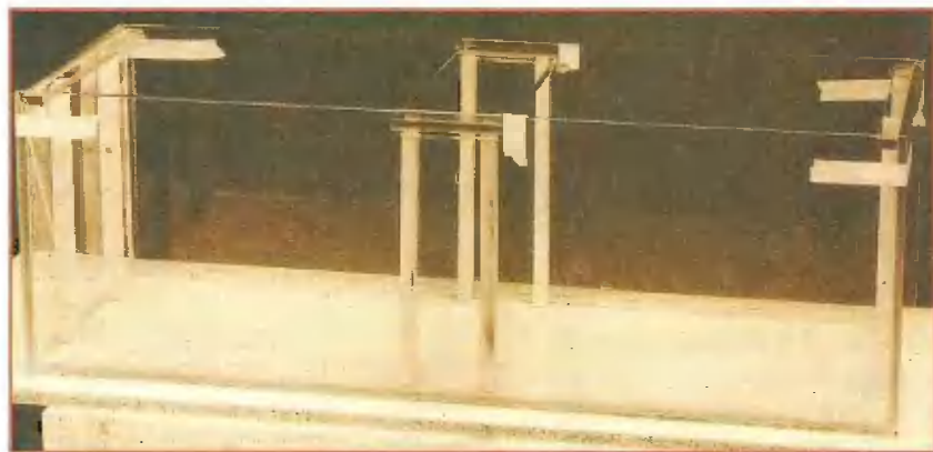
Аквариум в собранном виде. Чтобы зафиксировать положение поперечных стяжек, их подпирают деревянными брусками, которые, как и полосы клейкой ленты, можно удалить не ранее, чем через двое суток. Все это время передвигать или переносить аквариум не следует.
